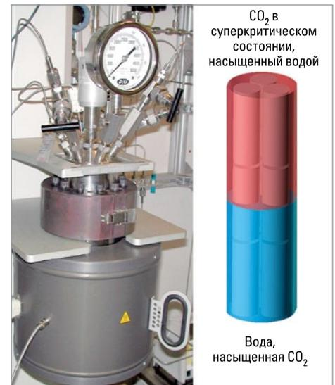
Реактор для оценки прочности в условиях влияния  $\text{CO}_2$ : пробы цементного камня одновременно тестируются в условиях критических концентраций  $\text{CO}_2$  с водой и в воде, насыщенной углекислым газом при высоких температурах и давлении.
