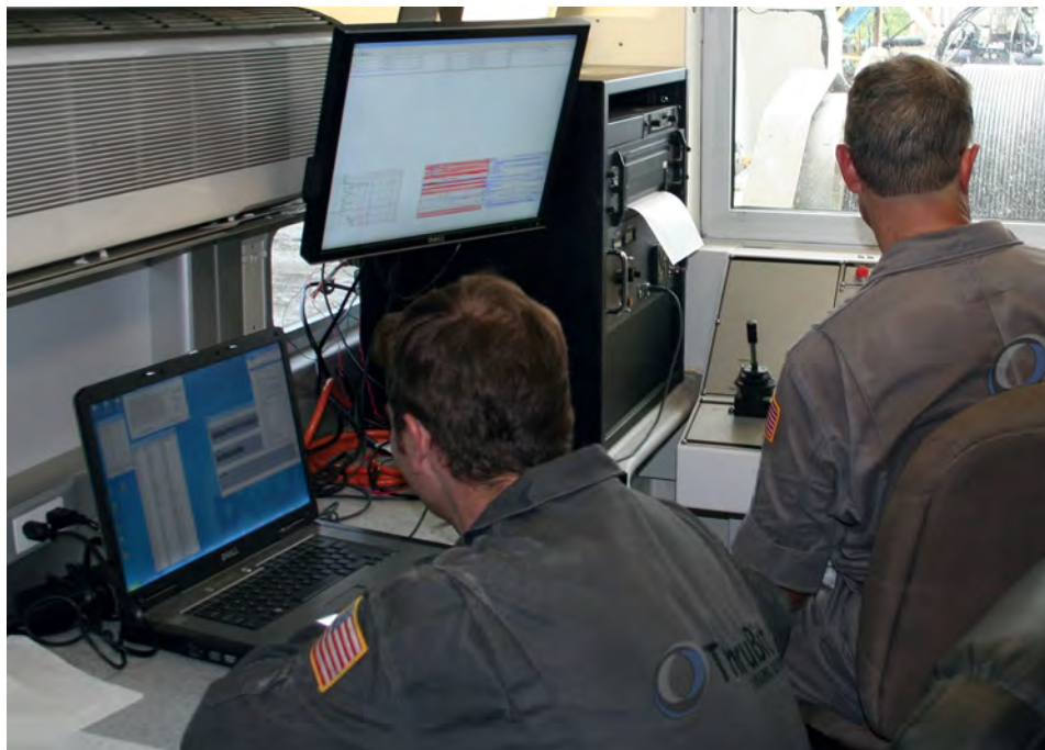
Благодаря кабельному соединению, инженер-геофизик контролирует работоспособность скважинной аппаратуры во время спуска и до момента перехода в режим записи данных в память, также производится запись во время спуска.
