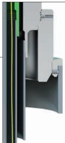
Модель без обсадной колонны 20"
