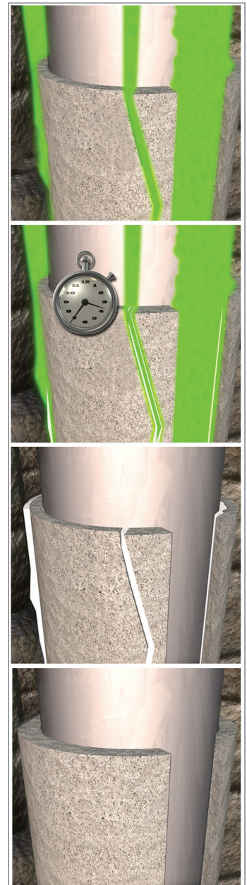
Поток углеводорода (зеленый) активирует цементный камень FUTUR в любой момент, когда целостность цементного кольца нарушена, при этом поток устраняется и восстанавливается гидравлическая изоляция.
