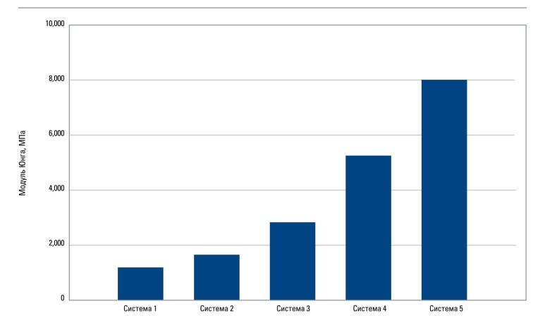
Все системы FlexSTONE, представленные ниже, имеют плотность 1437 кг/м<sup>3</sup> и одинаковое содержание твердой фазы. Каждая из систем может быть спроектирована и создана в соответствии с потребностями заказчика по степени эластичности цементного камня, а также другим показателям, которые будут признаны необходимыми для проведения работ на месторождении.
