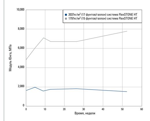
Продолжительное высокотемпературное тестирование. Данные по испытанию цементной системы FlexSTONE HT в течение года при температуре 200оС. На графике наглядно показано стабильное состояние цементной системы, отсутствие признаков потери эластичности цементным камнем по истечении одного года.
