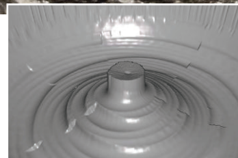
Профиль забоя, образованный долотом PDC с алмазной вставкой Stinger в ходе испытаний (вверху) и во время моделирования в системе IDEAS (внизу).
