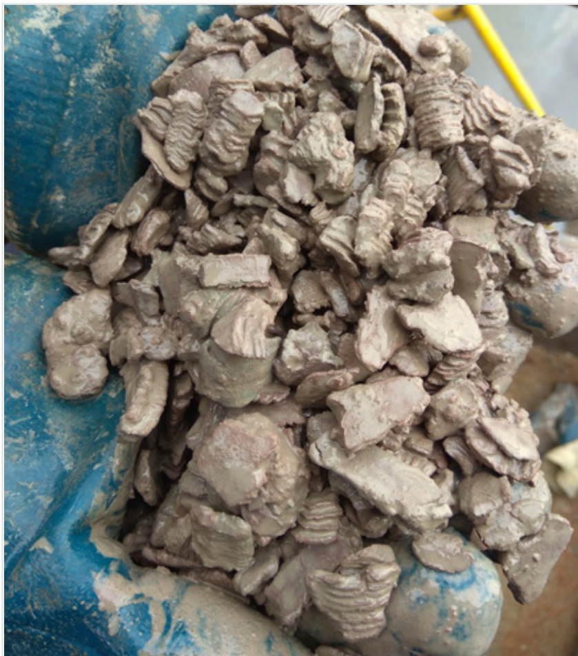
Выбуренный шлам (красная глина Нижнего Триаса с глубины 1500м, видна работа долота)
