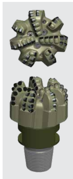
Долото SHARC MDSi716 PDC диаметром 8½ дюйма с PDC-резцами ONYX II премиум-класса и рядом вспомогательных резцов обеспечило повышенную сопротивляемость абразивному износу и термической деструкции, а также позволило увеличить длительность рейса долота.
