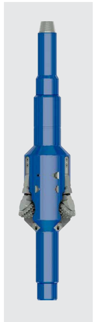
Раздвижной расширитель имеет три раздвижных лапы с режущими элементами, которые раздвигаются и удерживаются в открытом положении за счет постоянного гидравлического давления.
