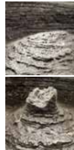
Профиль забоя, образованный стандартным долотом PDC в ходе испытаний (вверху) и во время моделирования в системе IDEAS (внизу)
