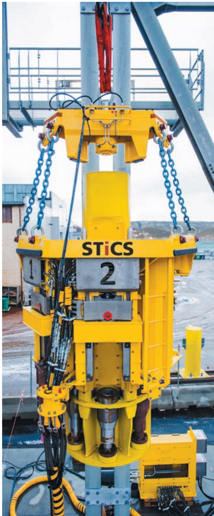
Система направления труб для свинчивания (STiCS)
