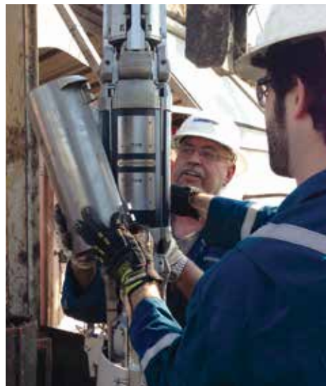
Защитный кожух используется во время транспортировки для защиты прижимных башмаков прибора Quanta Geo.
