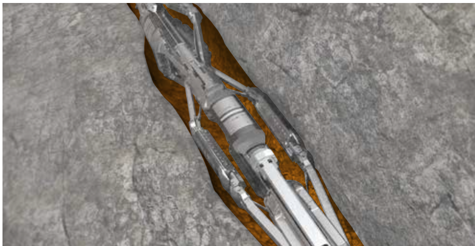
Восемь прижимных башмаков, расположенных на 4 последовательно соединенных лапах прибора, позволяют делать запись как во время спуска, так и во время подъема, снижая до минимума получение некачественных данных, из-за плохого состояния ствола скважины.
