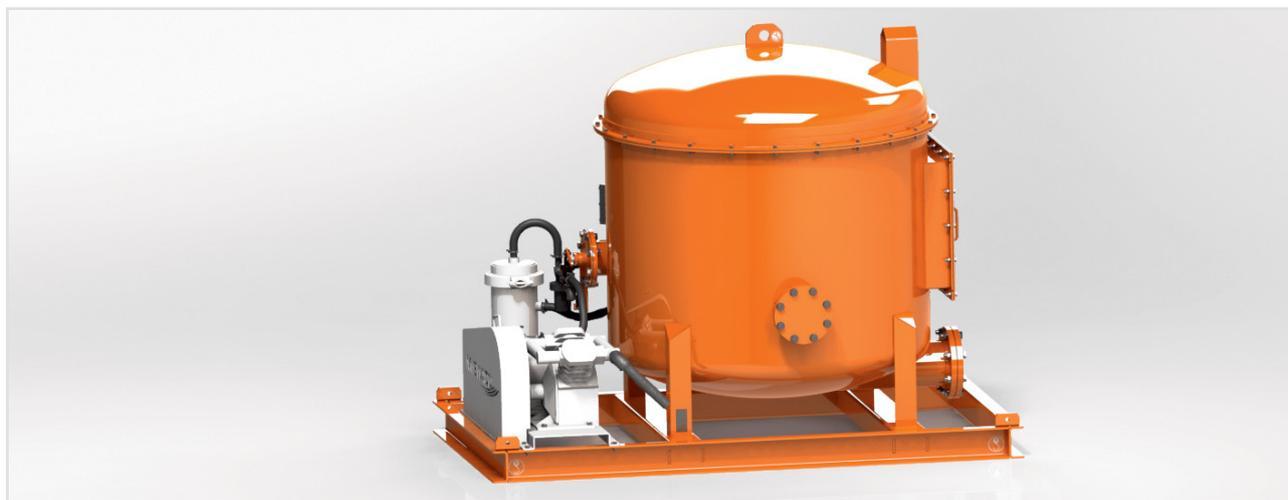
Компактный вакуумный дегазатор M-I SWACO удаляет увлеченные газы из бурового раствора. Вакуумная дегазация более эффективна, чем атмосферная дегазация, за счет того, что на буровой раствор воздействует давление намного ниже атмосферного.
