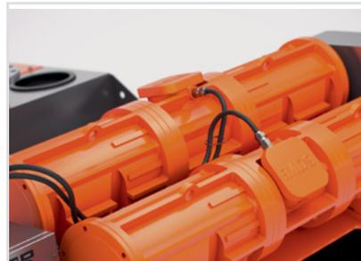
Два современных вибрационных двигателя мощностью 7 л.с. и скоростью вращения 1800 об/мин., протестированных в условиях промысла
