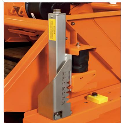
Высокопрочная, надежная механическая система регулировки наклона рамы. Домкраты с антикоррозионным покрытием.
