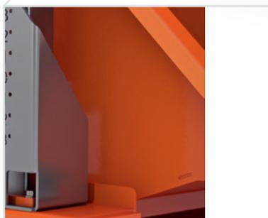
Угол наклона вибромамы можно регулировать в процессе работы вибрационного сита. Диапазон регулировки от  $-3^\circ$  до  $+3^\circ$
