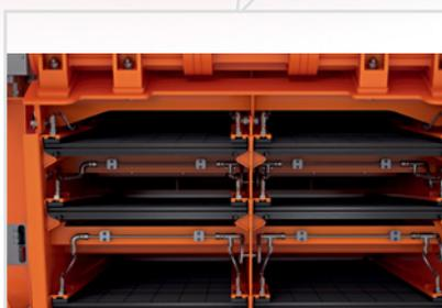
В базовую комплектацию вибросита входит скальпирующая рама и две основных рамы. Предварительно натянутые ситовые панели на композитном каркасе имеют следующие общие площади: Скальпирующая рама: 2,4 м<sup>2</sup> (25,4 фут.<sup>2</sup>) Основные рамы: 4,7 м<sup>2</sup> (50,8 фут.<sup>2</sup>)
