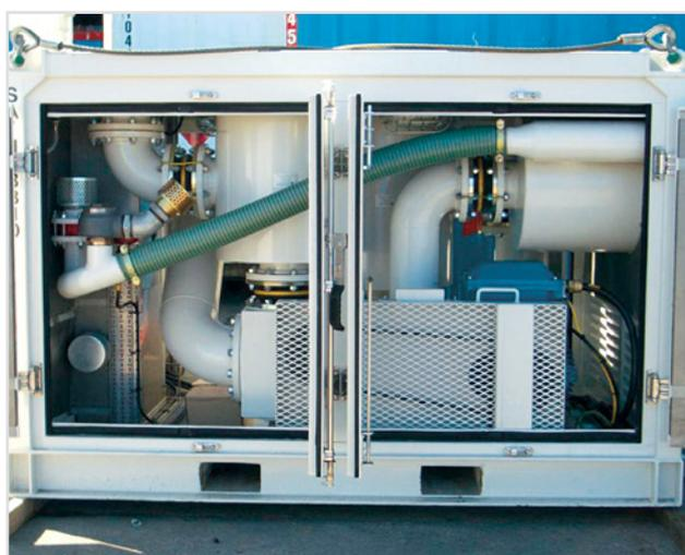
Модульные компоненты вакуумной системы сбора (VCS) позволяют использовать ее для широкого ряда работ на буровой установке, в том числе:
