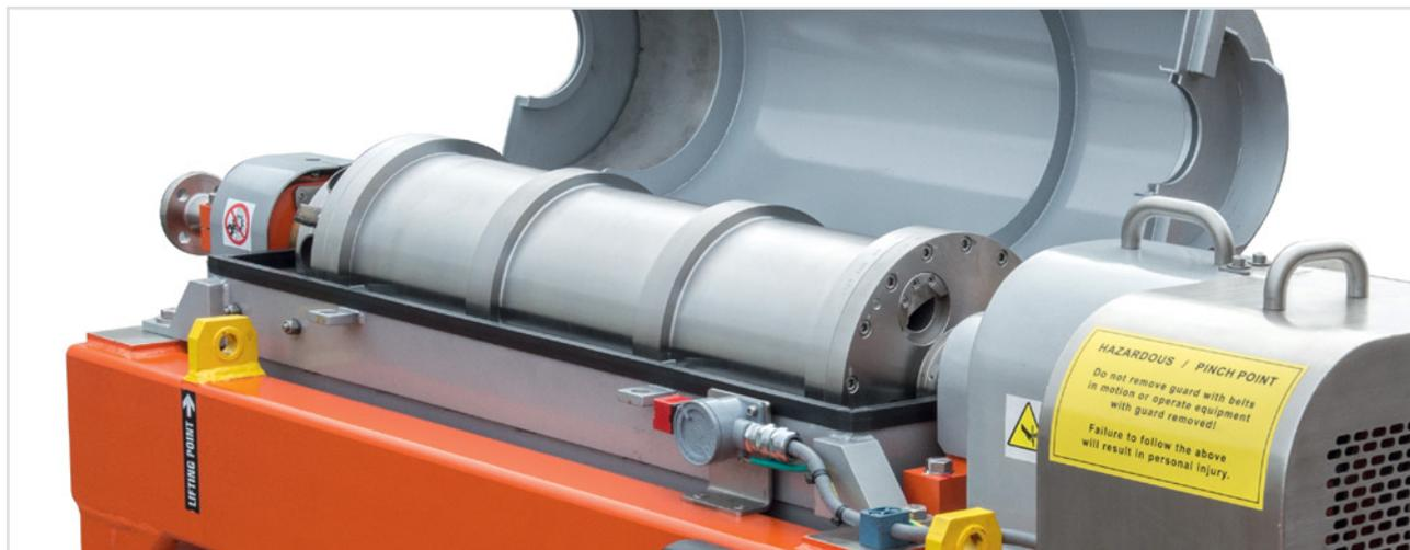
Центрифуга CD 250 – самая малогабаритная из всего парка центрифуг, отличается простой системой управления, надежной конструкцией, и не требует много времени для установки и демонтажа. Эта центрифуга восстанавливает дорогостоящий буровой раствор, сокращая объем отходов.
