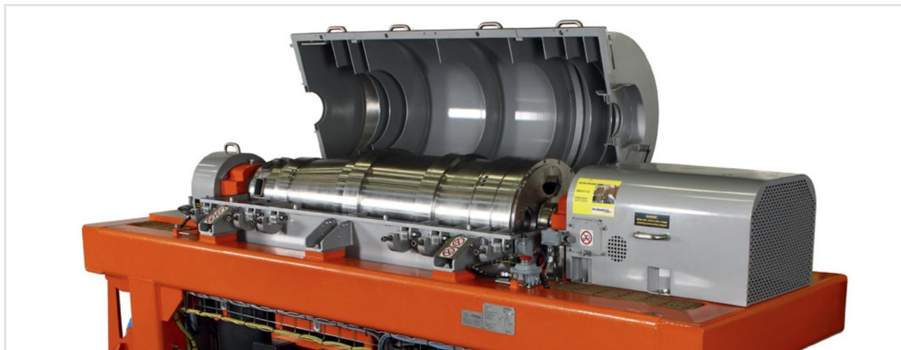
Высокопроизводительная центрифуга CD 500 HV – это мощная центрифуга, предназначенная для отделения твердой фазы исключительно малой плотности и восстановления барита во время буровых операций на проектах, где требуется быстрая и качественная очистка больших объемов бурового раствора.
