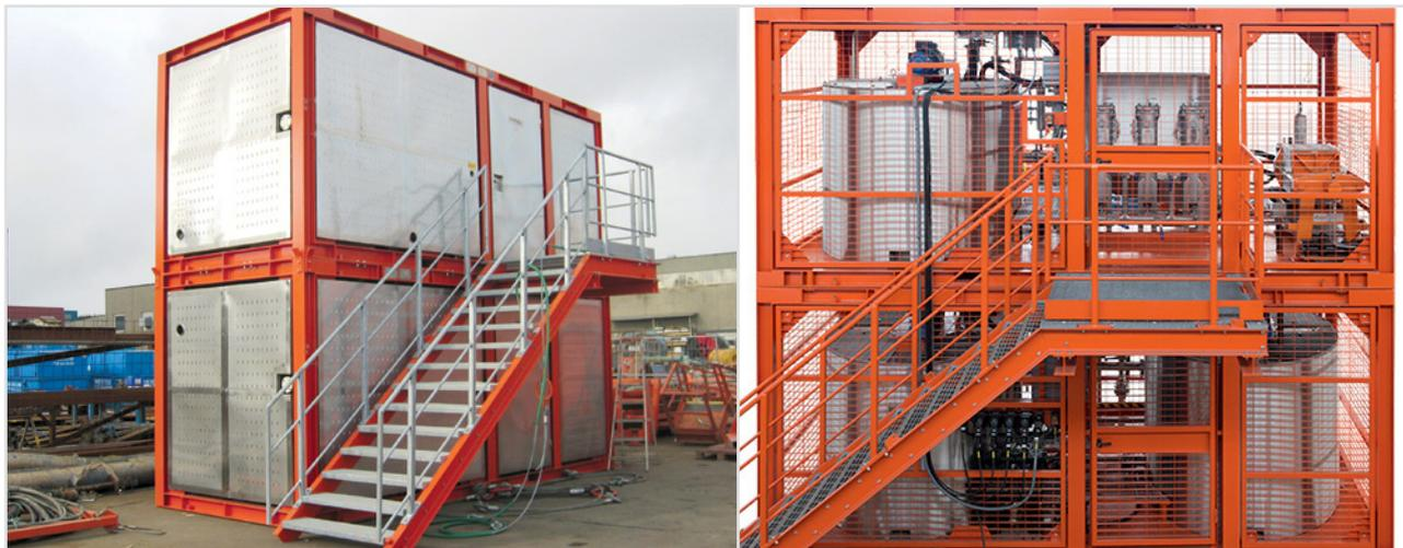
Теперь компания M-I SWACO может сделать технологические процессы механической и химической переработки жидких отходов, применяемые на береговом комплексе ENVIROCENTER<sup>†</sup>, доступными и на морских буровых установках. Это стало возможным благодаря модулю ENVIROUNIT<sup>†</sup> – портативной версии комплекса ENVIROCENTER для применения на морских установках, где химические и механические технологические процессы аналогичны применяемым на береговом комплексе.
