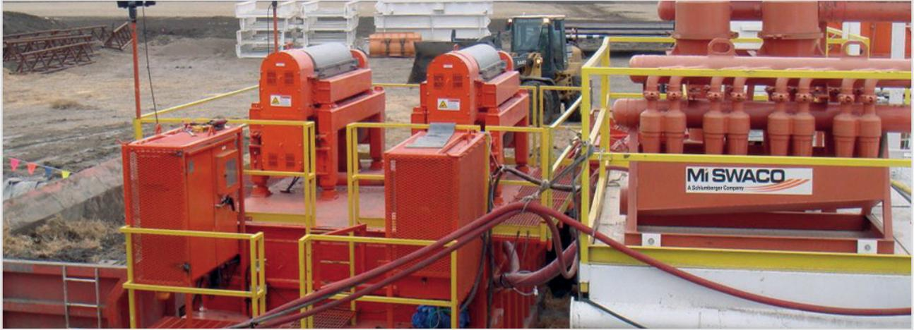
Система удаления твердой фазы OPTM-IZER<sup>†</sup> представляет собой мобильную установку с замкнутым технологическим циклом, созданную для экономии времени, трудозатрат и расходов, связанных с монтажом оборудования во время проведения буровых работ на суше.
