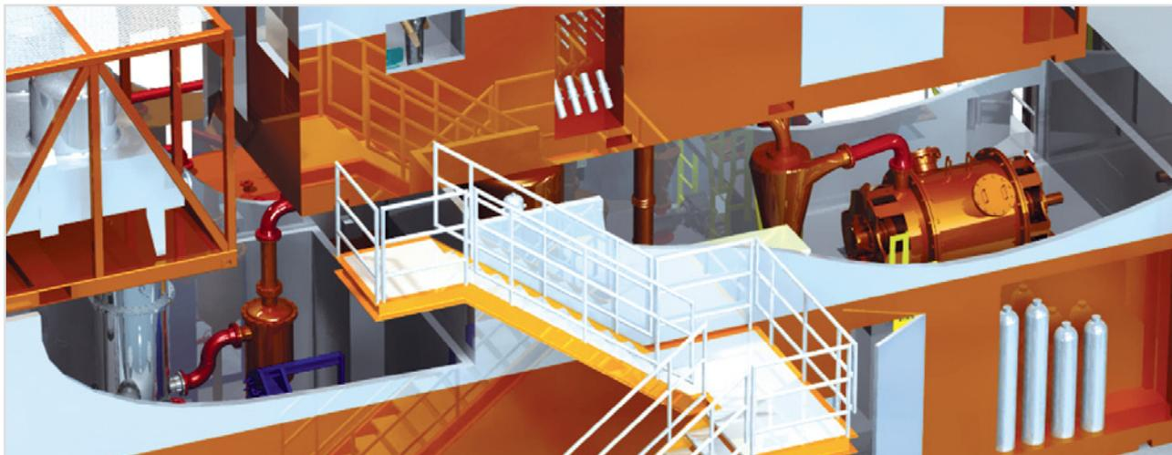
Установка «HAMMERMILL» специально спроектирована для использования на морских буровых установках, и может быть смонтирована в пространстве, которое раньше было занято открытыми контейнерами для сбора и транспортировки бурового шлама на берег.
