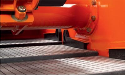
Используются три сетки (MONGOOSE) на композитном каркасе
