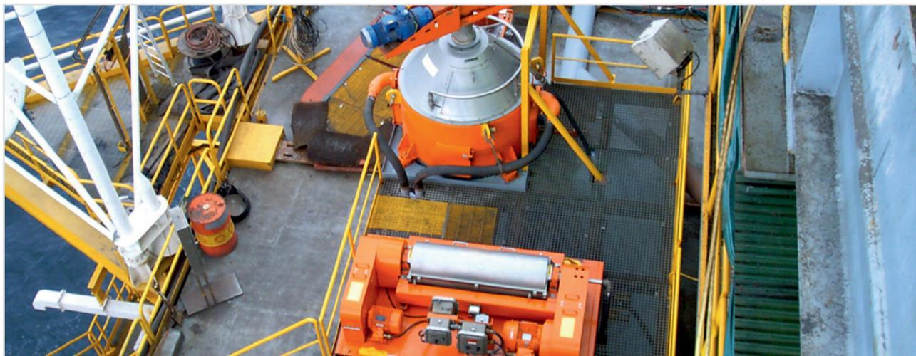
Осушитель шлама VERTI-G† имеет современную конструкцию, благодаря которой он может обрабатывать изменяющиеся количества бурового шлама и раствора, обычно при производительности до 60 тонн (61 метрических тонн) в час. Остаточная влажность шлама (по массе) в среднем менее 5%..
