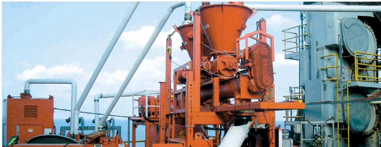
Вакуумная система сбора VACUUM COLLECTION SYSTEM<sup>+</sup> (VCS<sup>+</sup>) компании SWACO осуществляет сбор, транспортировку и хранение бурового шлама без доступа к окружающей среде, что сводит к минимуму утечки и загрязнение.
