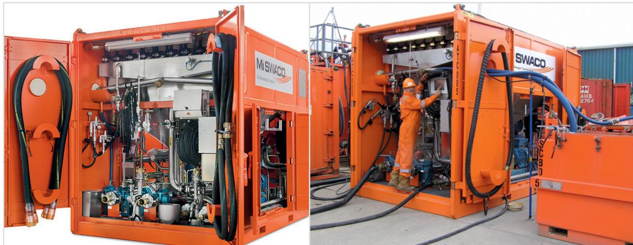
Компания M-I SWACO модернизировала медленный, трудоемкий, грязный, и потенциально опасный процесс очистки резервуаров (емкостей), внедрив свою систему автоматической очистки емкостей (AUTOMATIC Очистка емкостей <sup>†</sup>), которая полностью автоматизирована, предназначена для сокращения времени очистки емкостей, позволяет уменьшать количество отходов или исключить необходимость работы людей в замкнутом пространстве.
