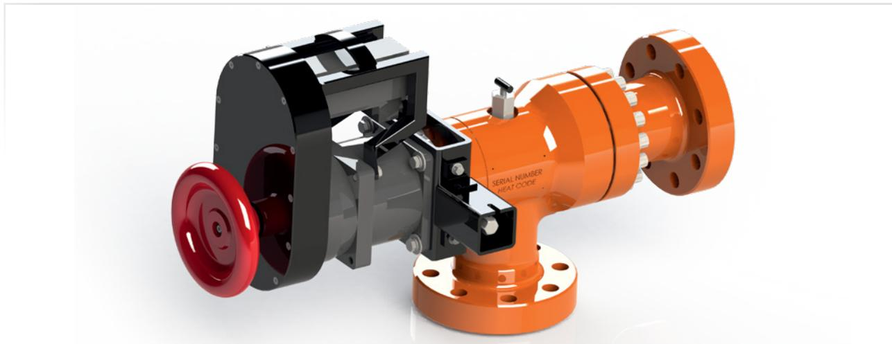
В состав блока управления дросселем ECHOKE<sup>†</sup> входит электронный активатор, локальный приводной блок, и электронный дистанционный пульт управления. Блок ECHOKE является электронным устройством, заменяющим гидравлический блок управления SUPERCHOKE и активатор.
