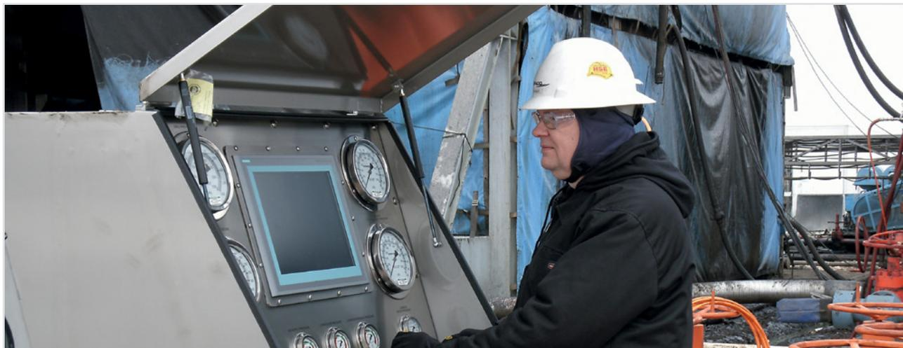
Система управления дросселем низкого давления LOW PRESSURE AUTOCHOKE<sup>†</sup> CONSOLE (LPAC<sup>†</sup>) компании M-I SWACO позволяет точно регулировать давление в скважине в режиме бурения на депрессии или с управляемым давлением.
