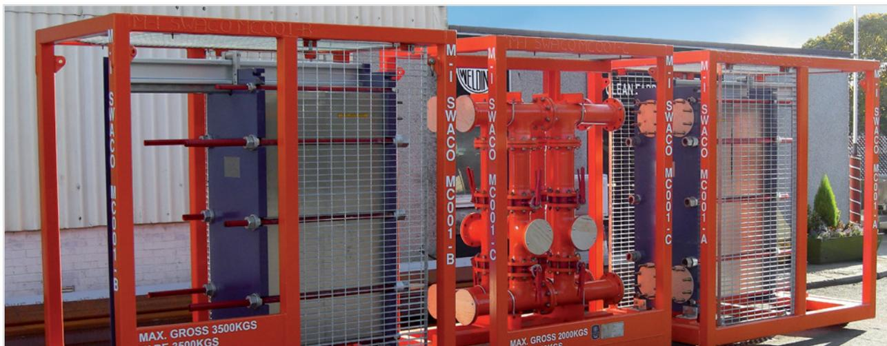
Система контроля температуры бурового раствора (DRILLING FLUID TEMPERATURE CONTROL SYSTEM<sup>†</sup>) была создана специально для снижения рисков и осложнений, связанных с бурением скважин в условиях АВПД/АВПТ с использованием буровых растворов на углеводородной основе.
