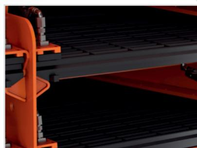
Пневмоподушки в виде непривычных распорных лент, позволяют закреплять ситовую панель, начиная с разгрузочного конца вибросита
