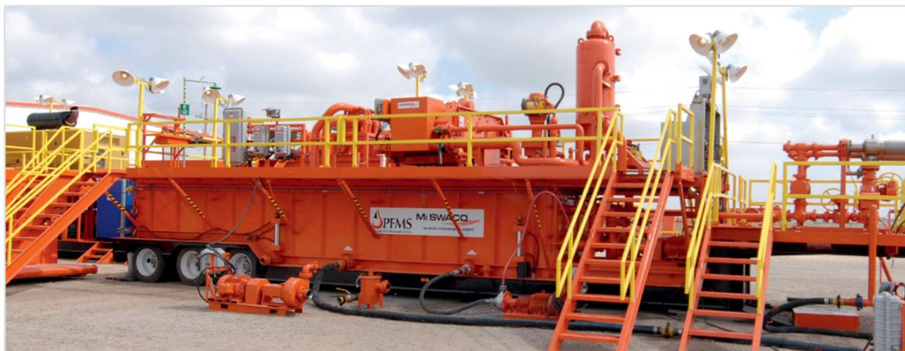
Компания M-I SWACO разработала свою уникальную систему управления давлением при бурении «PRESSURE AND FLUID MANAGEMENT SYSTEM» специально, чтобы удовлетворить специфические требования при выполнении работ на гибких насосно-компрессорных трубах (койлтубинг), когда требуется высокая точность при управлении давлением и контроле содержания твердой фазы, при малых габаритах оборудования.
