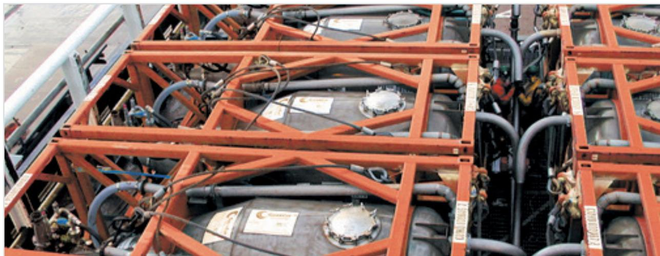
Запатентованная система CLEANCUT<sup>†</sup> компании M-I SWACO предоставляет заказчикам гибкое решение для повышения безопасности и эффективности при обращении (локализация, транспорт) с отходами бурения. Выбуренная порода улавливается сразу на выходе из вибросита и остается в герметичной системе на всем протяжении технологического цикла транспортировки, который обеспечивает пневматическая система.
