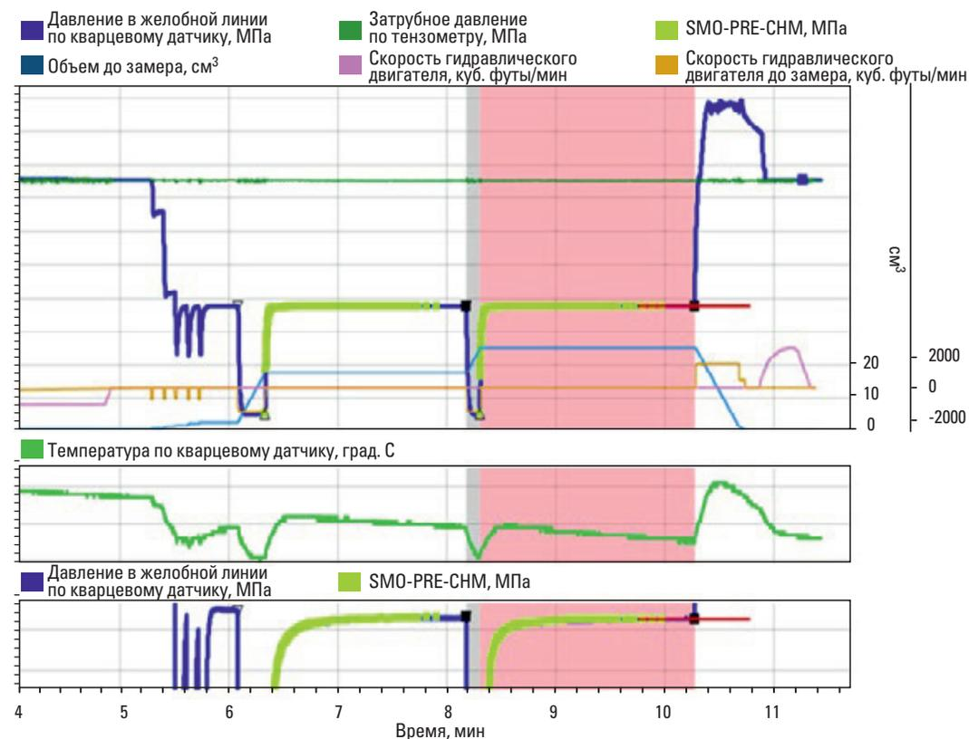
ООО «НОВАТЭК-Юрхаровнефтегаз» использовало прибор StethoScope для измерения давления во время бурения и выполнила в общей сложности 59 замеров в секциях диаметром 311,1 мм, 215,9 мм и 155,6 мм. Прибор продемонстрировал повышенную прочность при различных динамических и статических нагрузках, что позволило избежать прихвата. Благодаря прибору StethoScope были получены данные измерений в пластах, которые обычно считаются недоступными для проведения каротажа во время бурения.
