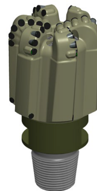
С помощью интегрированной инженерно-аналитической платформы IDEAS было спроектировано 215,9 мм (8 \frac{1}{2} -дюймовое) долото MDi616 PDC для наклонно-направленного бурения с резаками ONYX, обладающее повышенной износостойкостью специально для условий данной скважины
