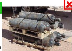
Неправильный способ транспортировки газовых баллонов
