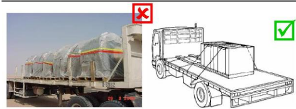
Грузы на поддонах не закреплены и не прижаты к торцу грузового отсека. ПОДДОН ПРИЖАТ К ТОРЦУ ГРУЗОВОГО ОТСЕКА
