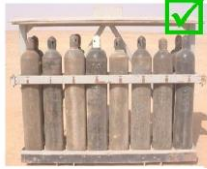
Транспортировка газовых баллонов на стеллажах
