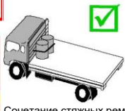
Сочетание стяжных ремней и прямого ограничения с использованием конструкции транспортного средства
