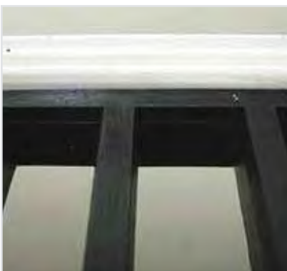
Вид снизу ситовой панели DuraFlo, на котором показано уплотнение, влитое в композитный каркас таким образом, что оно не может отделиться во время работы.
