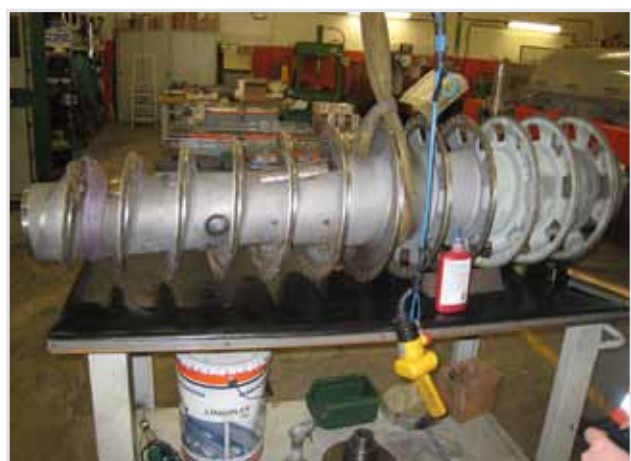
Новый шнек для центрифуги 518 с отверстиями и карбид-вольфрамовыми вставками
