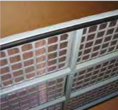
Ситовые панели с металлическим армированием состоят из нескольких компонентов: опорная пластина, стальной каркас и уплотнение; эти составляющие могут отделиться и прийти в негодность во время работы.
