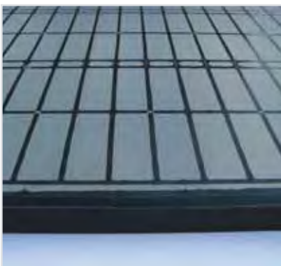
Вид сверху ситовой панели DuraFlo, на котором показано непосредственное крепление сеточного полотна к композитному каркасу.
