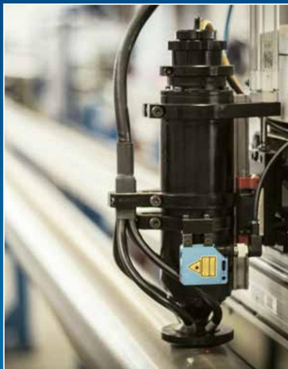
*Вверху: Система измерения размеров впускных щелей ResGauge\* - это фотометрическая система для контроля качества проволочных песчаных фильтров. Система измеряет расстояние между каждым витком фильтра.*
