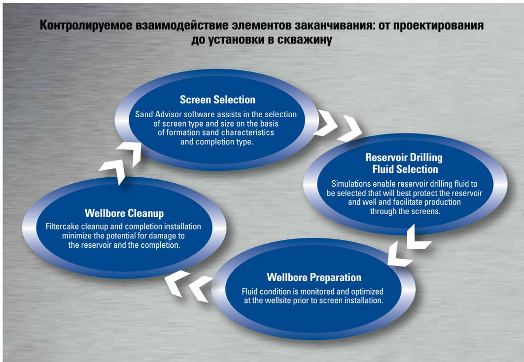
Контроль взаимодействия между пластом, фильтрационной коркой, буровым раствором и фильтром - ключевое условие успешной эксплуатации интервалов с автономными фильтрами.
