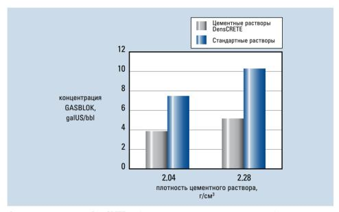
Для цементных растворов DensCRETE требуется меньшее количество химических добавок (например,GASBLOK\* для контроля газа) чем для обыкновенных цементных растворов такой же плотности. За счет этого уменьшается их стоимость и снижается воздействие на окружающую среду.
