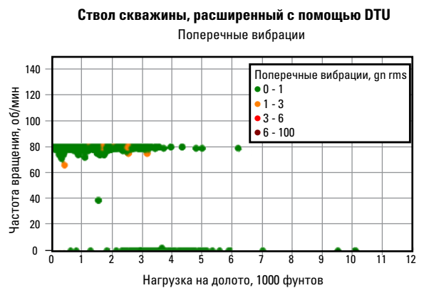
Применение расширителя DTU в составе КНБК позволило избежать значительных поперечных вибраций и неравномерность вращения, наблюдавшихся на соседней скважине, расширение которой выполнялось с помощью наддолотного расширителя другой сервисной компании.
