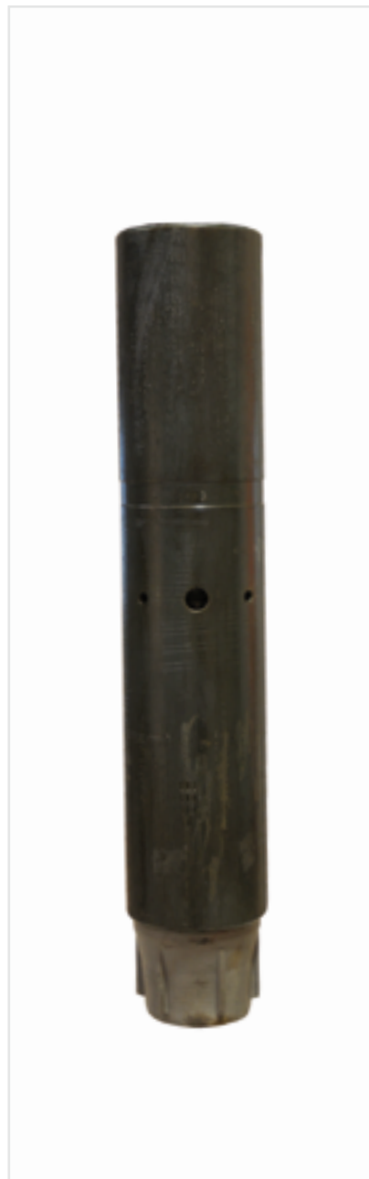
Рисунок 1. Инструмент Ported Bypass Sub спускается в скважину в закрытом положении.
