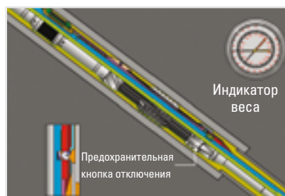
Рисунок 1. Поднять инструмент над потайной обсадной колонной и начать циркуляцию и восстановление свойств бурового раствора.
