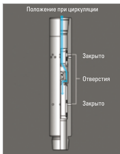
Рисунок 1. Нижние отверстия закрываются путем сброса шара и подачи давления.
