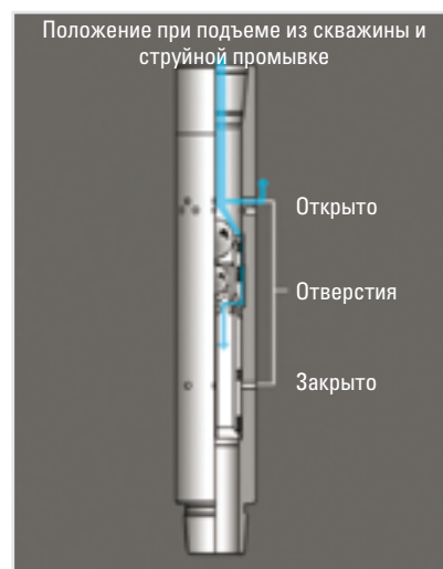
Рисунок 2. Верхние отверстия открываются путем сброса второго шара и подачи давления.
