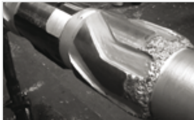
Рисунок 1. Закрепленная фрезерная муфта в нижней части инструмента
