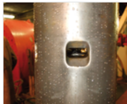
Открытые промывочные порты обеспечивают большую проточную площадь
