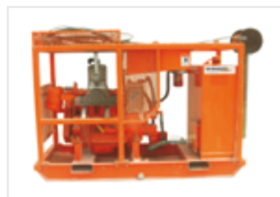
Резервная гидравлическая установка.
