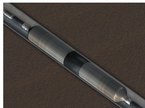
Мощная клинообразная пластинчатая система обеспечивает равномерное раздутие эластичного баллона для максимально надежного закрепления и уплотнения элемента.
