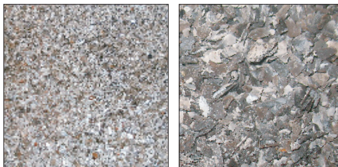
По сравнению с выбуренным шламом, полученным на соседней скважине (слева), шлам, полученный с долотом StingBlade (справа), был гораздо крупнее, что позволило лучше оценить свойства породы на поверхности.
