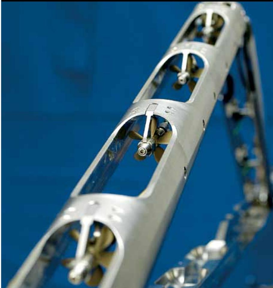
*Обычный расходомер замеряет поток в середине ствола скважины, вне зависимости от профиля потока, тогда как расходомеры Flow Scanner замеряют скорости на пяти различных уровнях по вертикальной оси ствола. Замеры усредненной скорости обычным расходомером не учитывают отрицательную скорость, которая замеряется нижним расходомером прибора Flow Scanner.*
