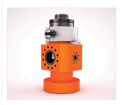
Устройство RCD 3 является компактным роторным устьевым герметизатором с герметичным подшипнико-уплотнительным узлом. В комплект устройства входит полный контур выравнивания давления и гидравлический клапан с дистанционным управлением, установленный на боковом выходном патрубке диаметром 71/16 дюйма. Персонал буровой может быть подготовлен для самостоятельного использования RCD.
