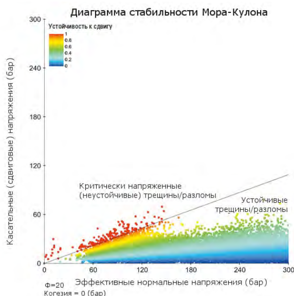
Расчет нормальных и касательных напряжений на плоскостях разломов и трещин, проверка критерия разрушения Мора-Кулона (слева) и стереодиаграмма ориентации трещин с учетом "расстояния" до нарушения их устойчивости (справа)
