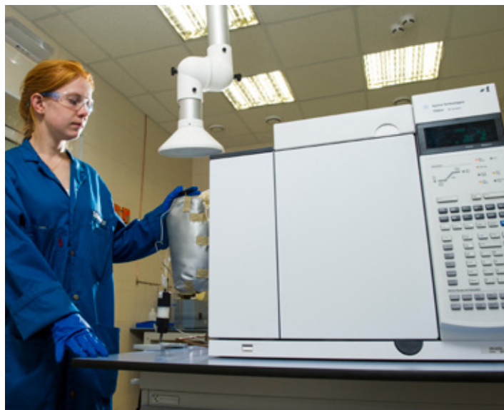
В лаборатории производится количественное определение компонентного состава газов и жидкостей. Специалисты придерживаются стандартизированных процессов, гарантирующих контроль качества при помощи интерактивного программного продукта Malsom*, предназначенного для изучения свойств пластовых флюидов.
