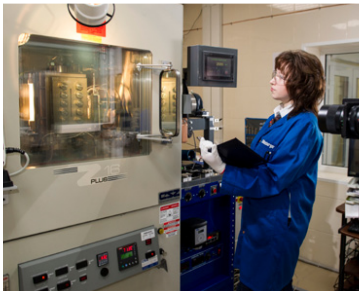
Безртутные PVT-ячейки позволяют выполнить все исследования по фазовому поведению для любого флюида, от газового конденсата до высоковязких нефтей.
