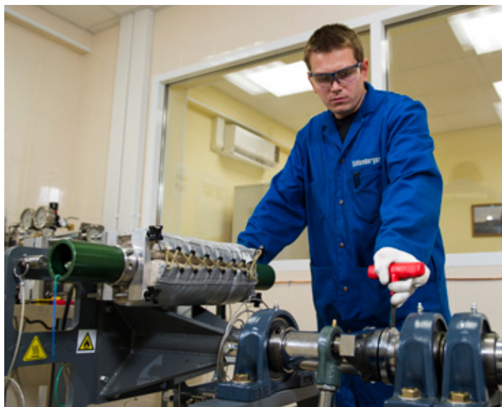
Восстановление проб в пластовых условиях (пластовое давление и температура) позволяет получить репрезентативные результаты. В лаборатории строго соблюдаются международные стандарты по предварительной подготовке проб перед исследованиями.
