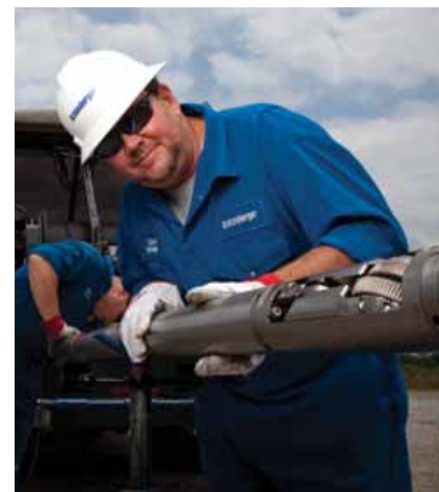
Подготовка ЗСТ TuffTRAC перед каротажем.
