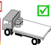
Сочетание стяжных ремней и прямого ограничения конструкции транспортного средства
