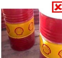
Незакрепленные бочки в кузове грузовика
