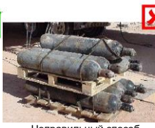
Неправильный способ транспортировки газовых баллонов
