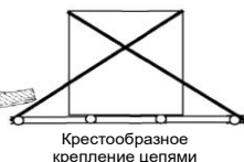
КРЕПЛЕНИЕ МОБИЛЬНОГО ЗДАНИЯ
