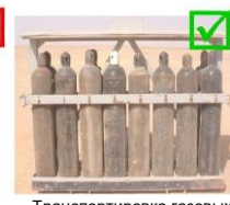
Транспортировка газовых баллонов на стеллажах
