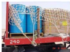
Используйте сетку для крепления грузов
