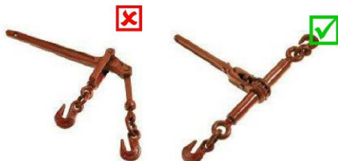
Стяжки для груза типа «brake-over» не должны использоваться в «Шлюмберге» в Омане
