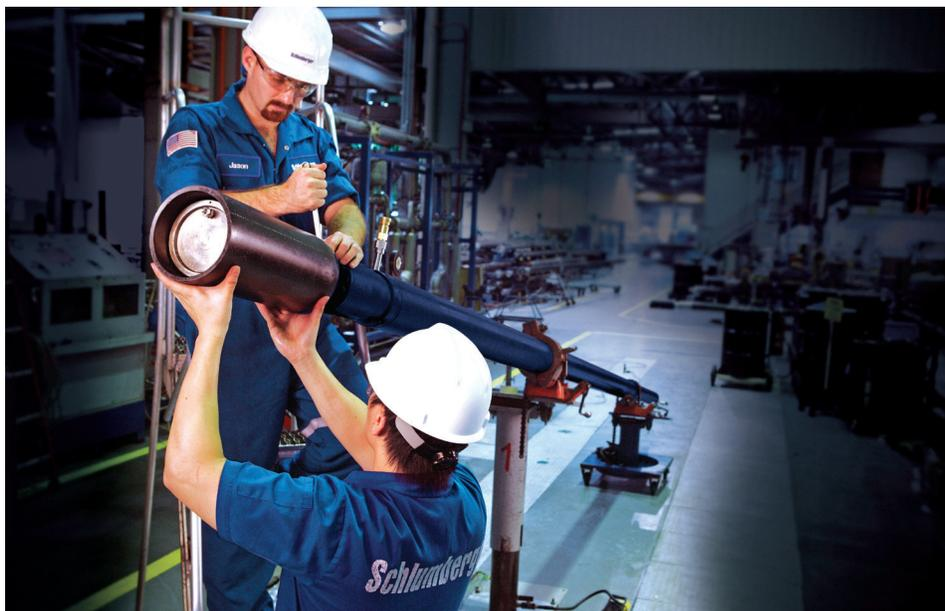
Рис. 1. Заполнение маслом электродвигателя REDA Maximus в заводских условиях.
